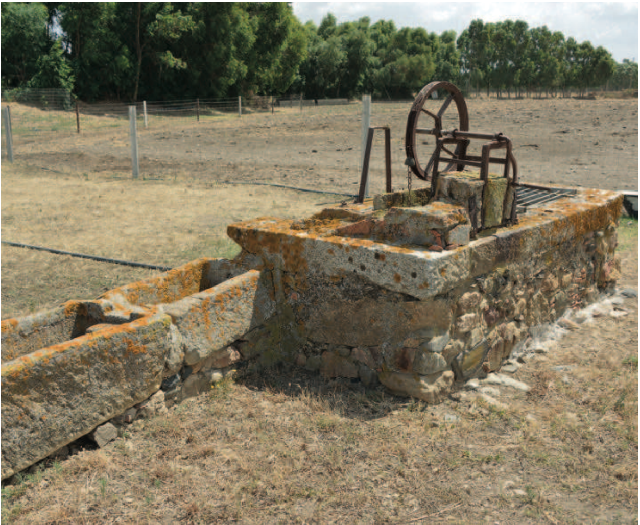
62. Ruota a tazze a manovella per il sollevamento dell'acqua in un abbeveratoio nelle campagne di Gonnosfanadiga (foto M.C.).
