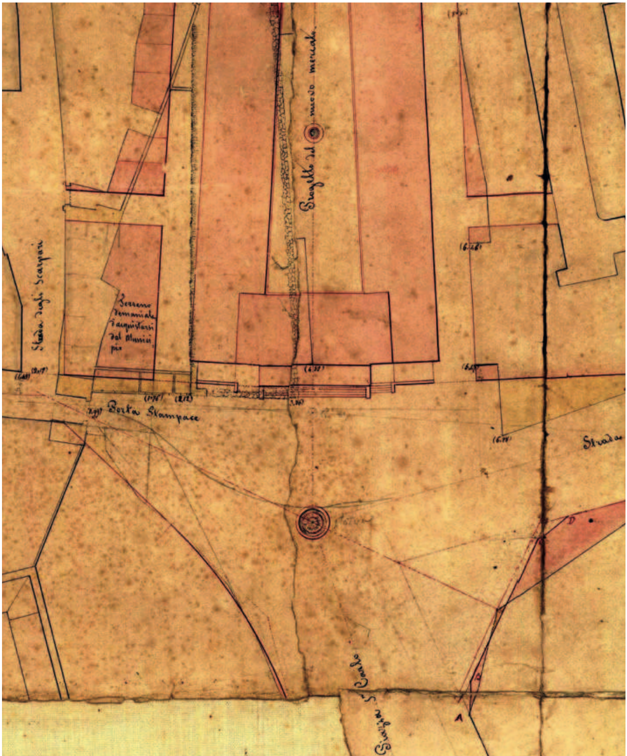
231 e 232. Progetto di collocazione di una fontana nel piano di rettilineamento dell'area di Porta Stampace a Cagliari, architetto Gaetano Cima, 19 giugno 1854, scala 1:500. Il progetto dell'area era funzionale alla costruzione del nuovo Mercato della città, cui Cima attendeva dal 1844. Il progetto della fontana in piazza a tre tazze si colloca, con altre tre, in funzione delle assialità stradali previste (da ASCCa, imgcartogr_serie G_G 12 I , e particolare).
