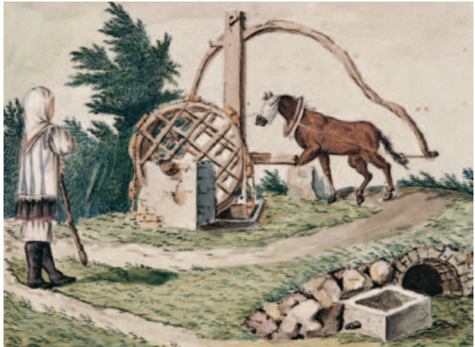
18. Anonimo, fontana cagliaritana. Una noria a tazze, datata 1812, per il prelievo da una sorgente coperta da una volta.
