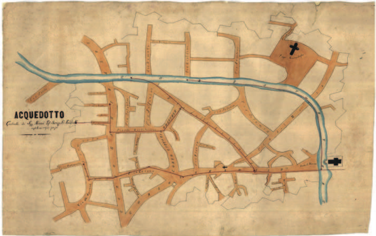
222. Planimetria di Monserrato, presso Cagliari, con la linea di derivazione dall'acquedotto principale costruita negli anni 1872-75-76. Il carattere ideogrammatico rivela la tecnica approssimativa degli estensori, i signori Fodde, Sarigu e Nonnoi (da ASCCa, imagcartogr_serieM_M16).
